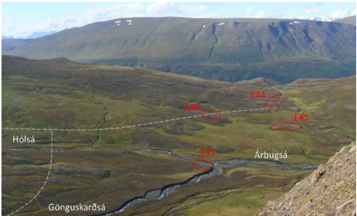
MYND 4.12 Fyrirhugaðir efnistökuastaðir ofan efstu strandlína jökullóna. Efnistökuastaður í lónstæði á Hólsdal sést ekki á myndinni. Lega aðrennsliþípu er sýnd með punktalínu.
